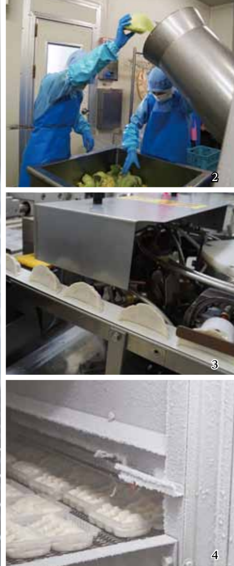
1.餃子が入ったトレイごと、少しずつ温度帯を変えながら、約5分30秒で蒸し上げます 2.半分に割り、芯を取り除いたキャベツは、異物がついていないかチェックしたあと、カット機に投入 3.皮で具材を包んで成形した餃子は17g。焼き色がつく面が三日月形になっています 4.巨大な冷凍庫の中を移動しながら約15分で冷凍。餃子の中央部分は-10℃の状態
