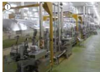
▲「おあげ(中)」の製造ラインが、新設されました。写真手前がフライ工程で、その後急速冷却され、写真②の検品・包装工程に続きます。
